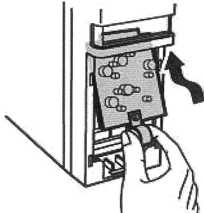
**3** 设备内印刷电路板两侧的连接器
