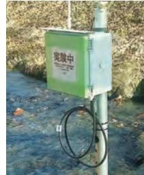
写真の水位計(河川の水位監視)に汎用送信基板が使用されています。
