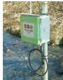
写真の水位計(河川の水位監視)に汎用送信基板が使用されています。
